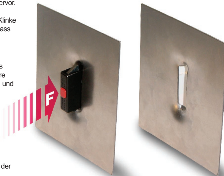
Der Herausziehversuch belegt die hohen Haltekräfte: Das Blech verformt sich, aber die D•SNAP-Befestigung hält.
